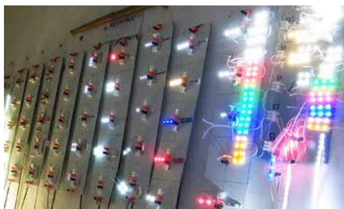
Dlouhodobé testování LED diod, modulů, pásek, LED zářivek v DENCOP LIGHTING
